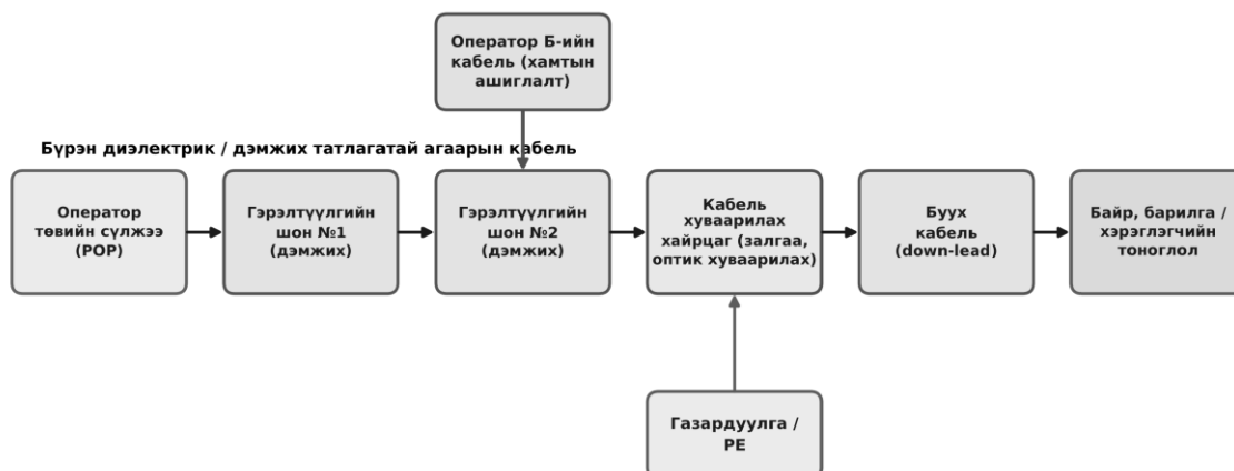
Схем 2 — Гэрэлтүүлгийн шон, кабель хуваарилах хайрцаг, агаарын кабелийн холболтын ерөнхий блок схем
