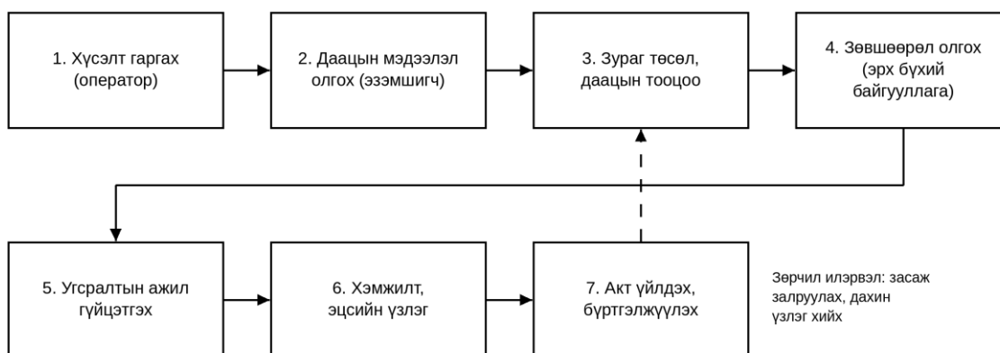
Схем 1 — Гэрэлтүүлгийн шонд суурилуулах ажлыг гүйцэтгэх байгууллагуудын үйл ажиллагааны блок-схем
