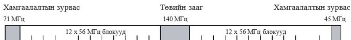
Зураг 6. Радио давтамжийн 31.8-33.4 ГГц-ийн зурваст ажиллах радио релейний системийн 56 МГц-ийн зурвасын өргөнтэй FDD суваг үүсгэсэн зураглал
