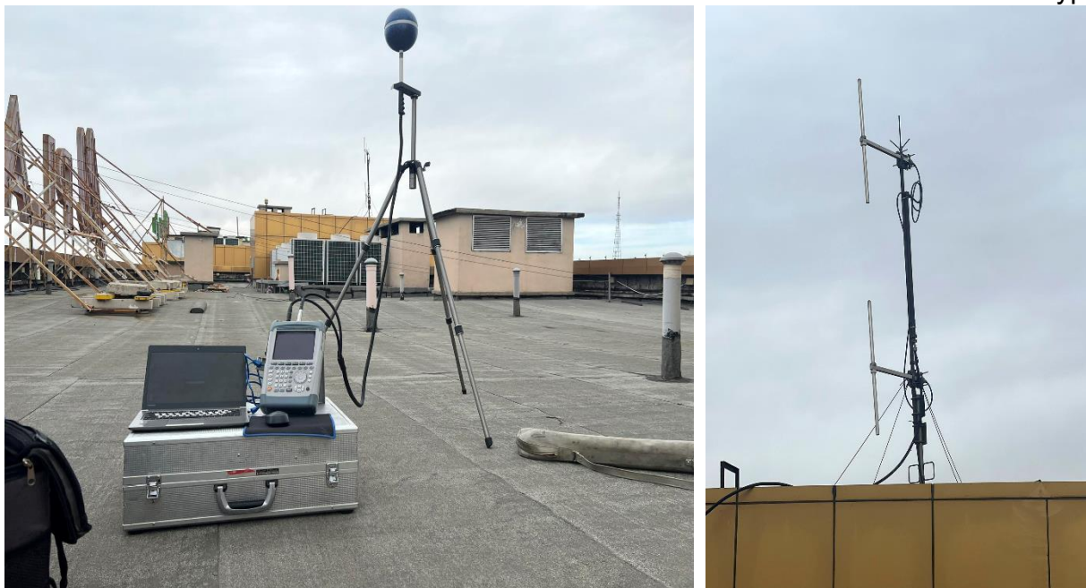
Зураг №1 ЧД 5-р хороо М Плаза барилгын дээвэр дээр хэмжилт хийж байгаа байдал
