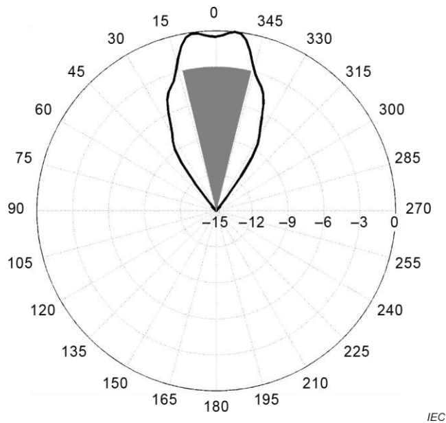
2-р зураг. 3 м зайд хязгаарын талбай нь сүүдэрлэгдсэн, 2 м EUT өргөнтэй RX антен E-хавтгай цацаргалтын загварын жишээ
